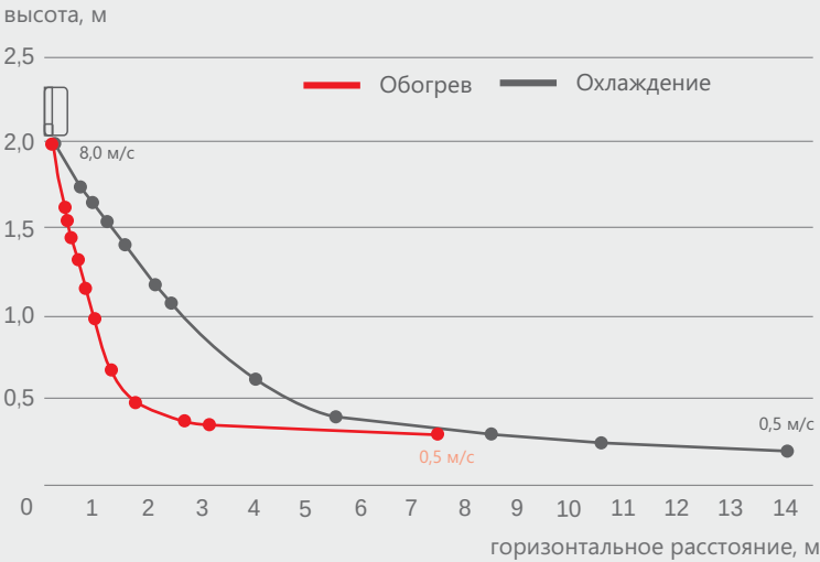
Максимальный воздушный поток сплит-системы 9,5 кВт
